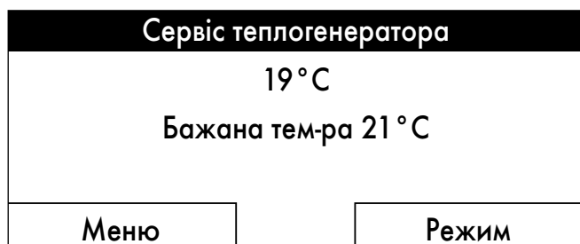
Мал. 6.1 Приклад повідомлення про необхідність технічного обслуговування
